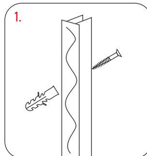
1. Sellar la parte posterior del perfil compensador. Luego fijarlo a la pared con los tornillos y los tarugos
