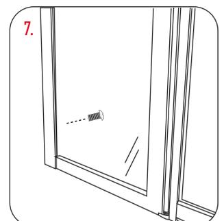
7. Perforar el perfil compensador desde el interior de la mampara, y fijar la misma con los tornillos.
