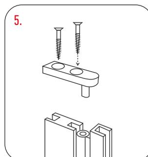
5. Fijar la bisagra con los tornillos.
